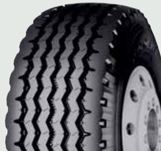
Широкопрофильная шина для магистрального/регионального применения разработана для установки на оси полуприцепа.
